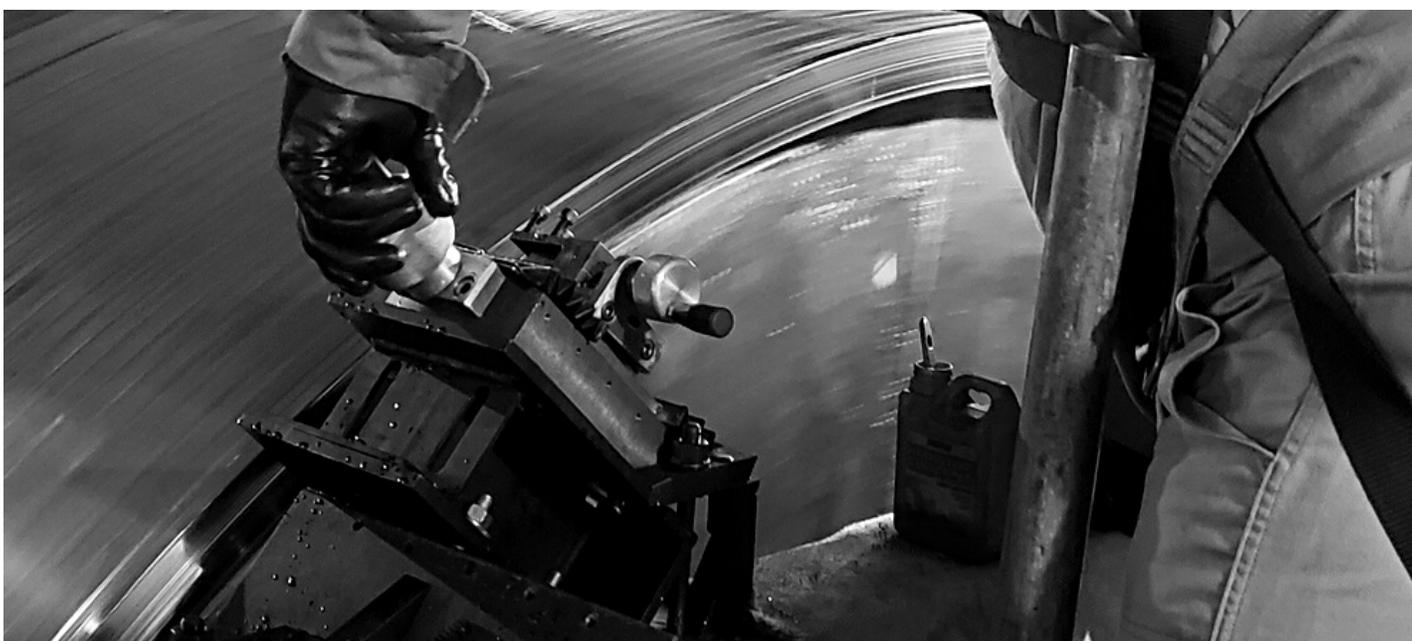
FOTO DE USINAGEM DE FACE LATERAL DE UM TAMBOR EM UMA EMPRESA DE PAPEL E CELULOSE.
