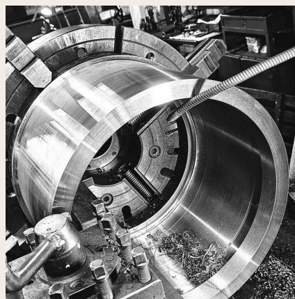
TORNEAMENTO DE BUCHA • CAVACO CONTÍNUO
