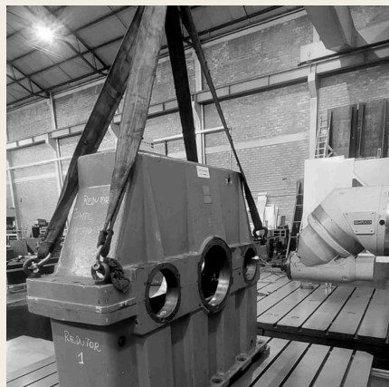
01 • POSICIONAMENTO POR PONTE ROLANTE
