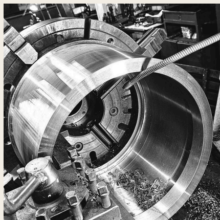
TORNEAMENTO EM PLACA DE QUATRO CASTANHAS
