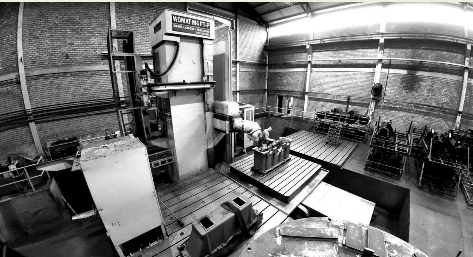
MANDRILADORA-FRESADORA HORIZONTAL • CARCAÇA DE REDUTOR CMPC NA MESA
