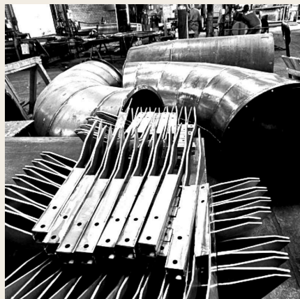
PÁS CONFORMADAS E CURVAS DE TUBULAÇÃO
