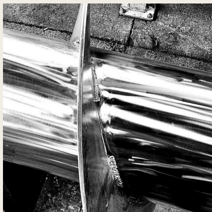
HÉLICE SOLDADA AO TUBO CENTRAL
