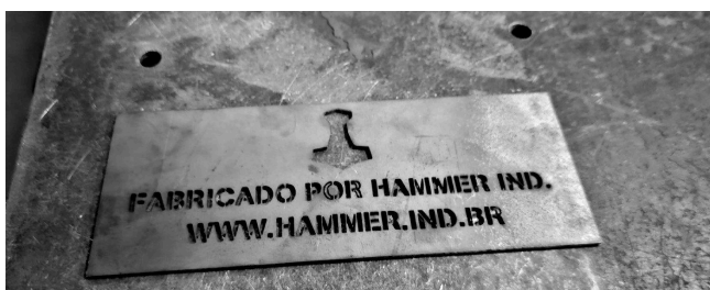
IDENTIFICAÇÃO CORTADA A LASER
