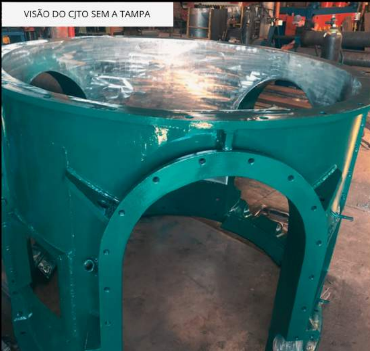
DETALHE DO REVESTIMENTO INTERNO NOVO
